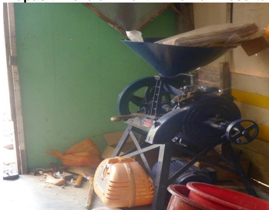
Gambar 2.23 Mesin Pengisar Kering Tidak Digunakan Kerana Tidak Bersesuaian Dengan Kapasiti Bekalan Elektrik Rumah Peserta
